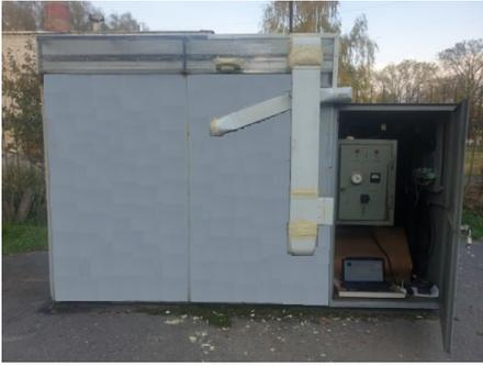
Рис. 2. Общий вид сушилки с комбинированным теплообменником
