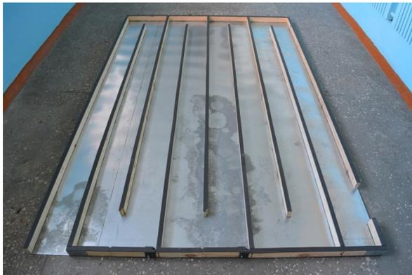
Рис. 3. Вид средней камеры комбинированного теплообменника
