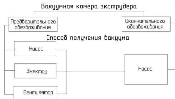
Рис. 1. Классификация вакуумных камер экструдеров
