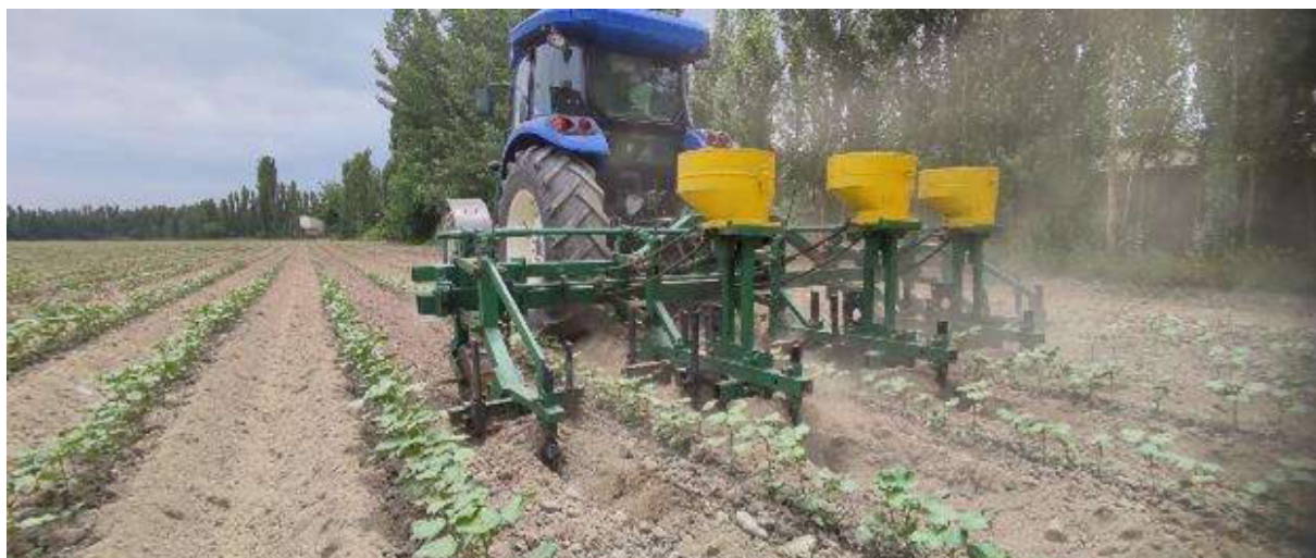
Рис. 3. Проведение полевых испытаний культиватора, оборудованного разработанными рабочими органами глубокого рыхления
